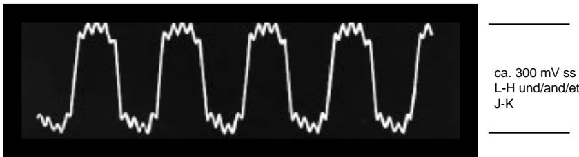
Fig. 16 TPH/U 062 mit Hall-Sonden (Motor zweiphasig)
